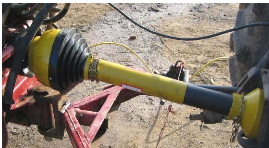
PROTECCIÓN Y SEGURIDAD Protecciones en la transmisión y en la toma de fuerza
