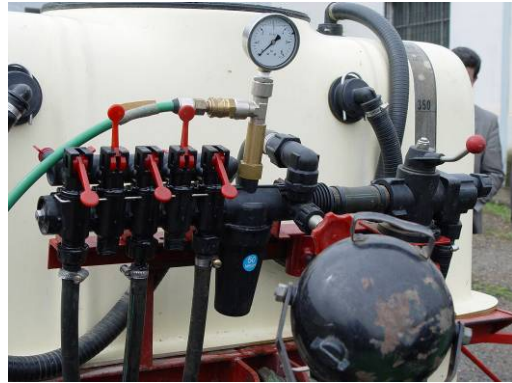
REGULADOR Y DISTRIBUIDOR Comprobación de funcionamiento
