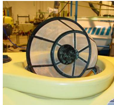
MALLA DE LLENADO Estado y limpieza de la malla
