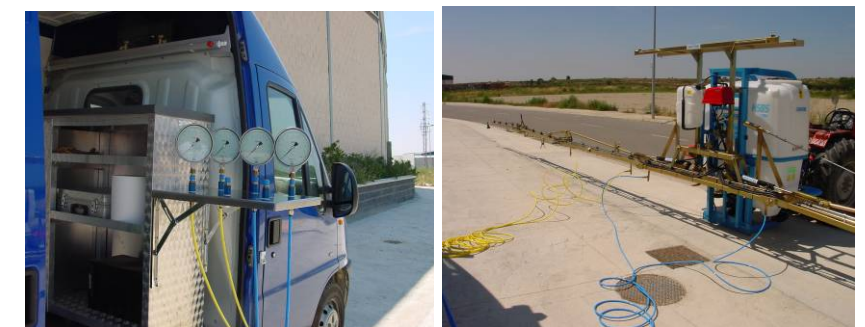
PRESIÓN DEL CIRCUITO HIDRÁULICO Comprobación de la variación de presiones entre sectores
