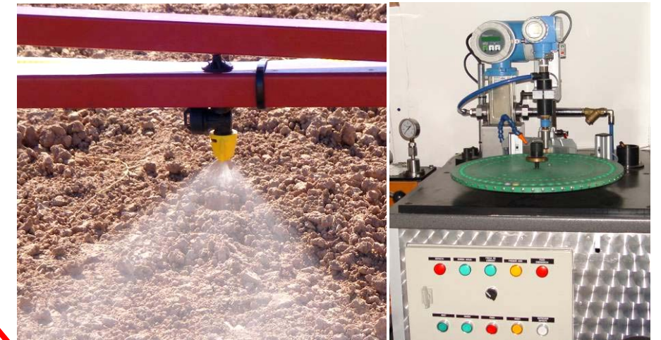
PRESIÓN DEL CIRCUITO HIDRÁULICO Comprobación de la variación de presiones entre sectores
